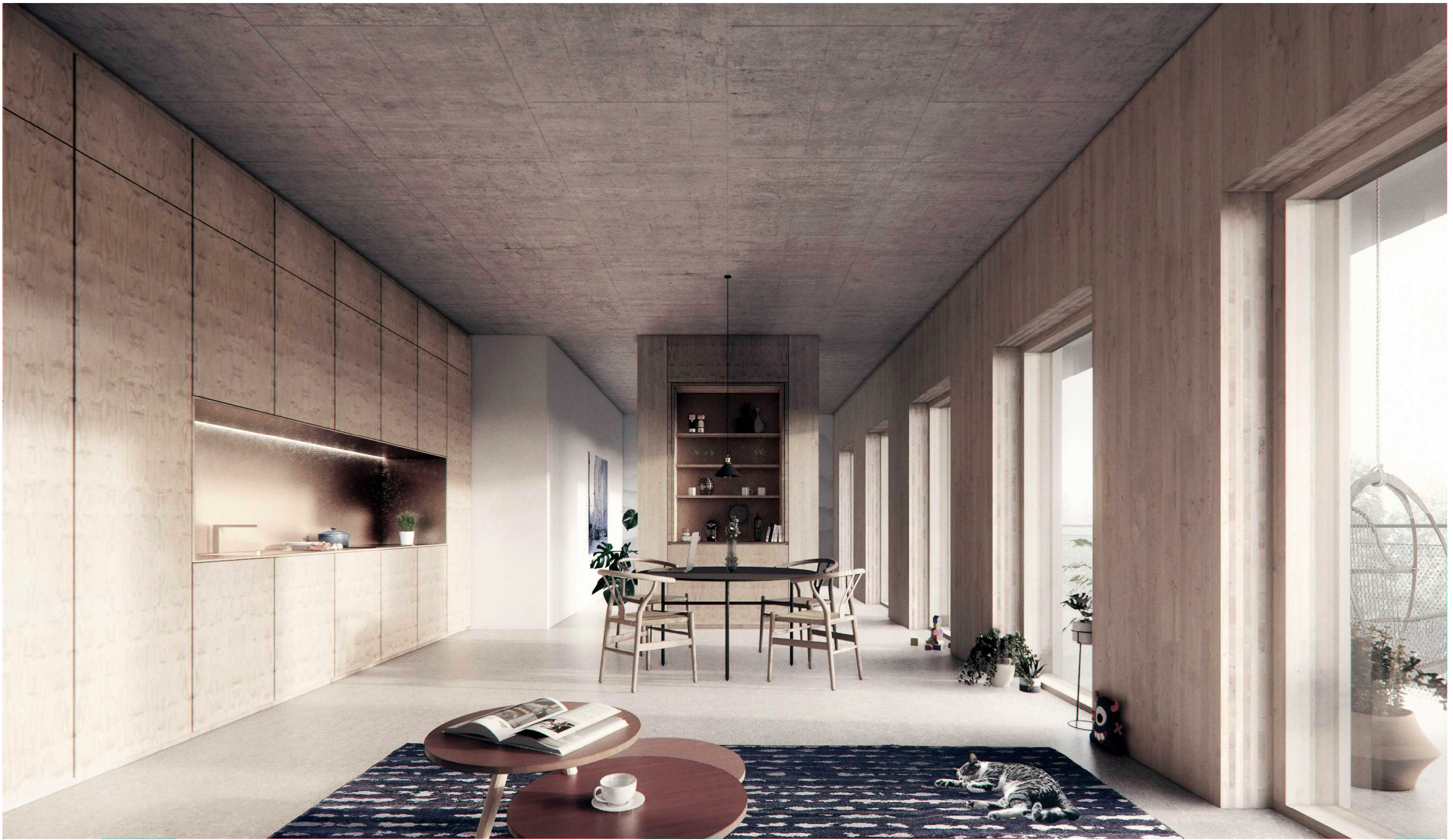
NÄKYMÄ ASUNNOSTA 60, 3H+KT+S 79,5m 2 Paikalla valetut välipohjat ja clt-seinät voidaan jättää näkyviin. Kalustekonseptilla pystytään toteuttamaan tilajakoja viimeistellysti ja materiaalitehokkaasti.
