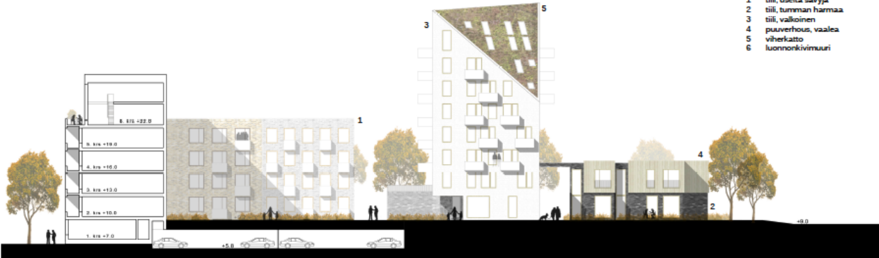
Julkisivu etelään pihalle / Leikkaus A-A 1:200
